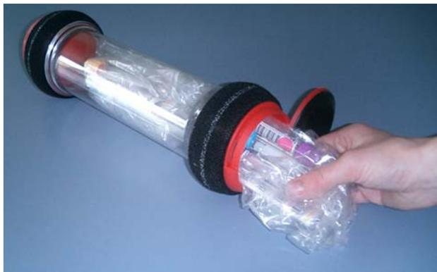
Rohrpostnutzer in **Haus 60** wickeln Plastiktüten um Röhrchen zur Pufferung und „stopfen“ eine oder mehrere in die Rohrpostbehälter .
