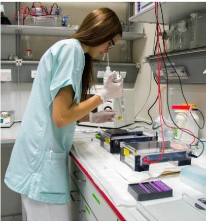
Rebekka Stockfleit führt eine Gelelektrophorese durch, bei der DNA-Fragmente ihrer Größe nach aufgetrennt und sichtbar gemacht werden.
